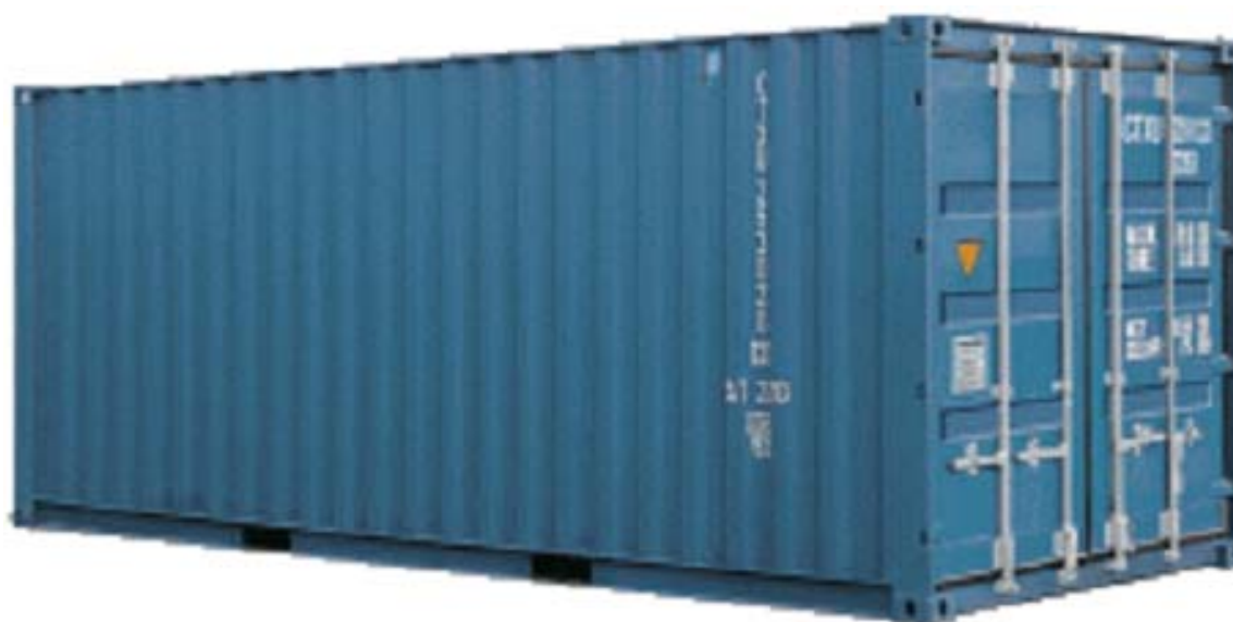
Рис. 1. 20-футовый стандартный контейнер ИСО: 6 х 2.4 х 2.6 м
